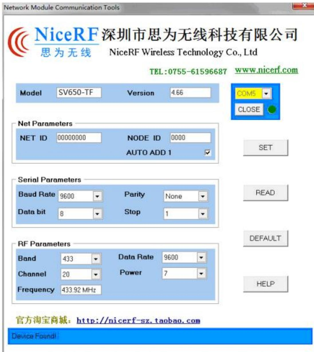
在模块正常连接后，模块便处于“可设置参数”的状态。用户可以通过 PC 界面修改模块的相关参数，如：工作频段、收发信道，空中通信速率，发射功率；串口波特率、数据位、停止位、奇偶效验位；NET ID, NODE ID 等，然后点击【SET】按钮对模块进行设置，每次参数成功改变后都会回传“OK”信息，PC 软件收到 OK 的回应后需弹出成功操作的提示对话框；否则输出“ERROR”，弹出操作错误的对话框，如 PC 发送指令之后 0.5s 内没有任何响应，则发生通讯错误，亦弹出操作错误的对话框。这些设置后的参数掉电均可保存。用户点击【READ】的按钮，模块将返回当前模块的所有参数信息。用户点击【DEFAULT】按钮将模块的参数设置为出
